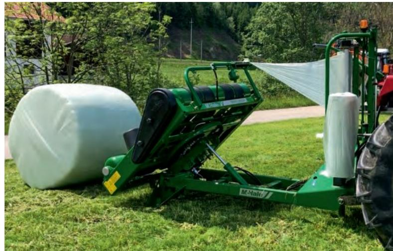
フィルムの伸びを一定に保ち、フィルムの使用量を最大化する750mmアルミ製ディスペンサー
