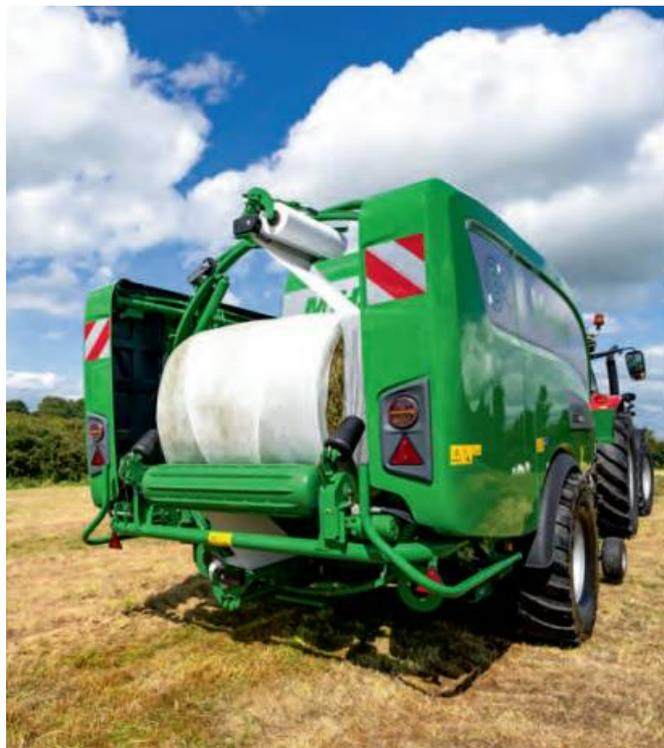
03 ベールがチャンバー内で形成されると、4つの大きなスプリングによるベルトテンションが油圧へ切り替わり、チャンバー内部のベール形成は、2つの油圧シリンダーによってチャンバーベルトテンションをコントロールします。
