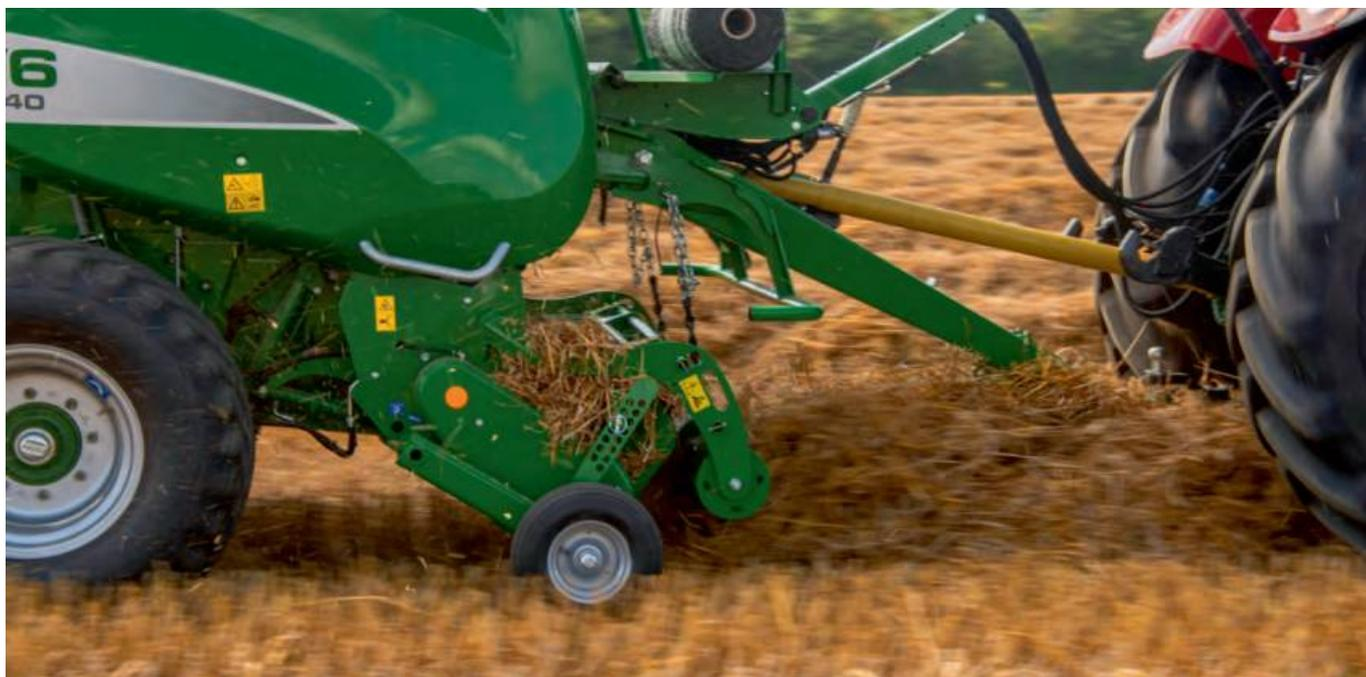
新しいテーパ状の供給口は、作物がピックアップからローターに向かってチャンバーへの流れと、処理能力を最大化します。マッকেール社は、オーガーを前方に移動させ、その先端をローター方向に傾斜させることで、作物の流れを改善しました。
