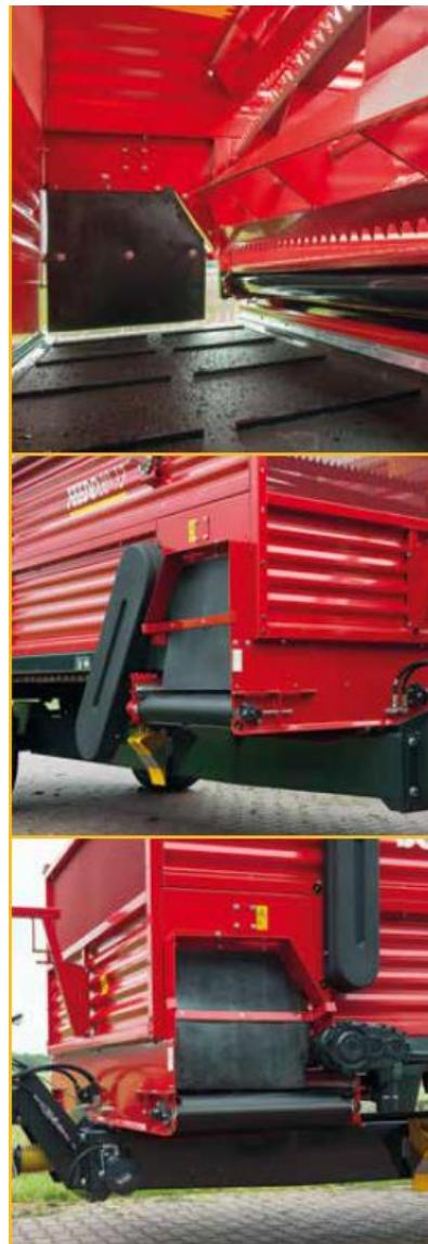
**FEEDO** は2連以上のピーターを装備してサイレージに過激に作用します。ピーターはそれぞれ直径が異なり回転速度にも差があります。これにより際立って安定した排出と種類の異なるサイレージの攪拌効果もたらされています。ピーターはPTOからの機械的な動力で駆動され、この特徴的なピーターとクロスコンベアによって一定量を安定的に排出して飼槽スペースを有効に活用しています。
