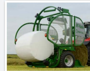
マッケールオービタルバールラッパーは、後側のラッピングローラーが下方向に動くことで、ラッピングされたバールを優しく地面に降ろします。オプションの縦起こし装置を使用すると、バールを90度回転させてラッパー端に降ろすことができるため、アルファルファのような硬い作物の茎によるフィルムの破れを軽減できます。
