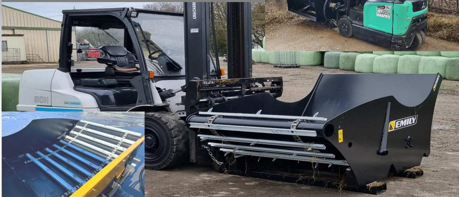
EMILY フォークリフト専用ベールアンローラーは シンプルで操作しやすい構造で どなたでも簡単にロールベールを解体、給餌作業が行えます。
