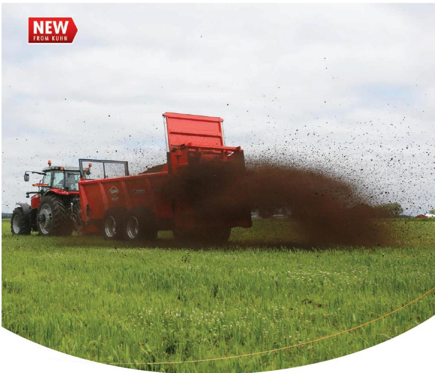
クーンナイトの新しいマニユアスプレッターです。大容量で酪農・育成・繁殖農家から排出する半液状、固形の糞尿を広範囲に散布できるよう設計されています。この製品は過酷なテストとユーザーの意見を反映させて斬新なスタイルと画期的な性能を備えたスプレッターとして誕生しました。上方に10度の傾斜で開放したサイドパネルはより大きな容量を確保すると同時に投入と旋回の容易さを維持しています。新たに開発されたギロチンゲートは排出量の調整を高精度で行えるようにしました。2分割のポリフロアと複式コンベアチェーンは原材料の搬送を確実に一定速度で行います。より高度に改良を加えたビーターの配置はフロアからビーターへの原材料の流れを効率化して散布パターンを高めています。更にスケールオプションを利用すると、詳細な散布状況をモニターしながら記録することができます。
