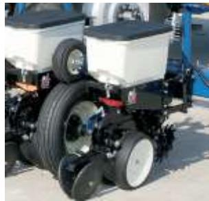
駆動は 接地タイヤと駆動タイヤで確実に
