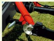
**衝突ダメージに対する保護** スプリング式インパクトガード は、障害物への衝突ダメージか ら保護します。
