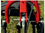
**適合性** 調節可能なロワーリンクピン は、異なるトラクターおよび タイヤサイズへの装着を可能 にします。
