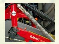
一定の負荷軽減 標準的で一体化されたスプリン グリリーフにより、低い接地圧 力で草地が保護されます。
