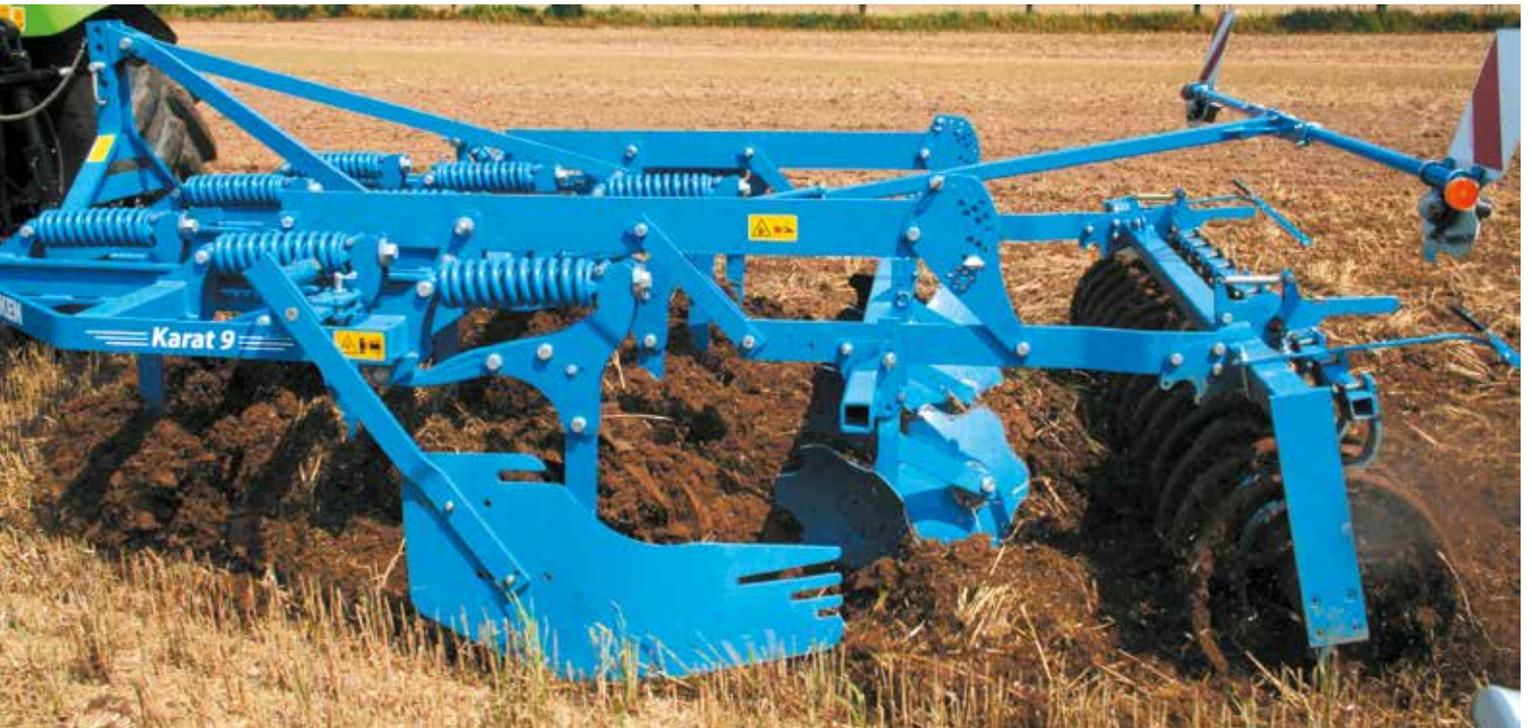
作業幅 3~7mの場合、インテンシブカルチベーターカラット 9のタインは、中程度のタイン間隔約28cmでカルチベーターのフレームに装着され、土とストローが十分に混和されます。左右対称のタイン配置が、横ブレのない作業を保証します。
