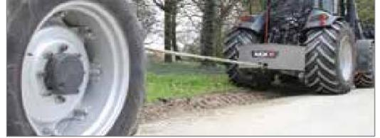
水平に最適な高さに配置された一体型牽引クレビス良好な最低地上高を維持しながら、けん引します。強力な直径30mmのピンと安全クリップ。
