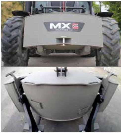
すべてのMULTIMASS Conceptウェイトは、強度と耐久性を高めるためにヨークタイプの設計で機械的に溶接されています。
