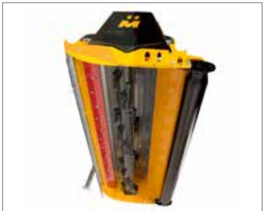
無段階調整可能な粉碎速度を実現します。その結果、理想的なマルチング品質と細断性能が得られます。
