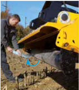
付属の工具で簡単にサポートローラーを調整可能。
