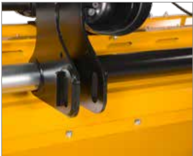
ロアリンクのスロット穴により、均一な刈り高での優れた地面追従性を実現
