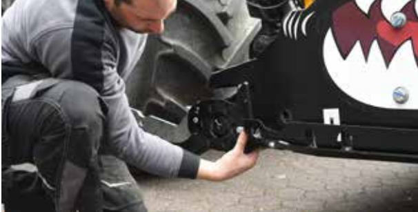
付属の工具で簡単にサポートローラーを調整可能。
