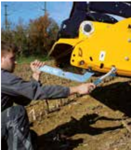
付属の工具で簡単にサポートローラーを調整可能。
