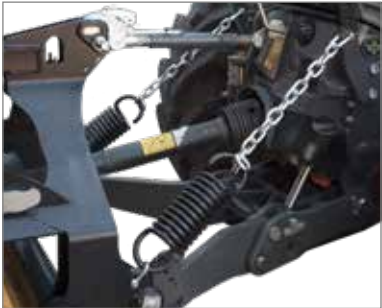
フロント衝撃吸収スプリングは、最適化された地面追従性を提供し、フロントアクスルへの荷重増加によりトラクターのトラクションと操舵特性を向上させます。（オプション）
