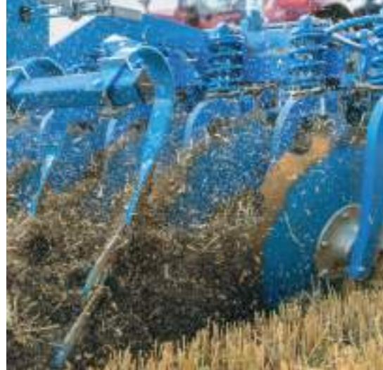
従来、コンパクトディスクハローは、作業深度約14cm以下の土壤および大量の有機物を集中的かつ均一に混和するために使用されてきました。
