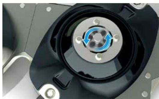
過負荷装置がせん断 - モアディスクがフリーに回転駆動が保護されます。
