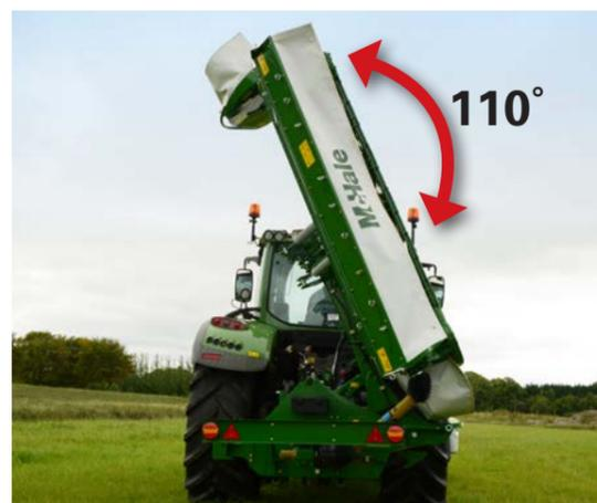
安全な輸送のために、マッকেールプログライドは、トラクターの中心位置後部にモアを折りたたみます。モアカッターバーを110度の角度に折りたたむことで、モアの移動高さを減少します。
