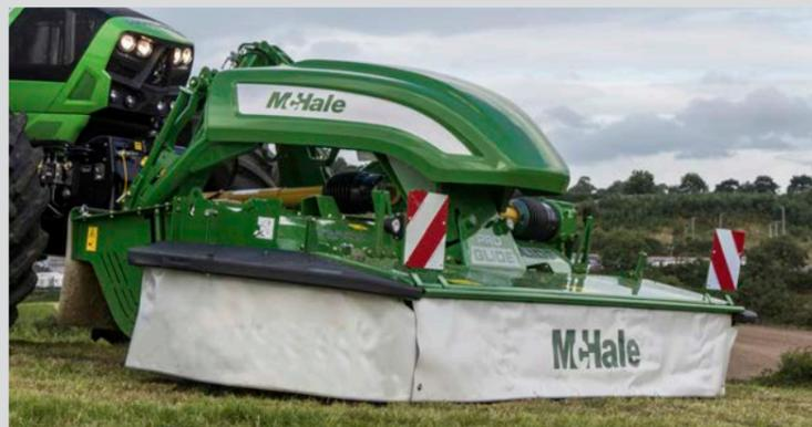
マッケールの設計チームは、モアの重心を可能な限りトラクターに近づけるようにプログライドフロントモアのフレームを設計しました。その結果、圃場条件の変化に応じて俊敏に対応します。
