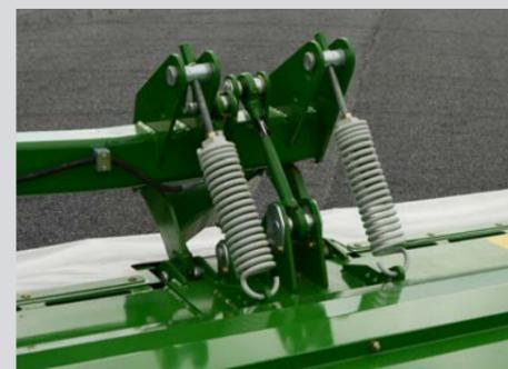
ほとんどのリヤモアにはセンターピンが装着され、これによってモアは圃場状態の変化に合わせて左右に動くことができます。マッケールプログライドの特許取得済みの3次元の圃場追従サスペンションユニットの装備によってさまざまな動作を可能にします。
