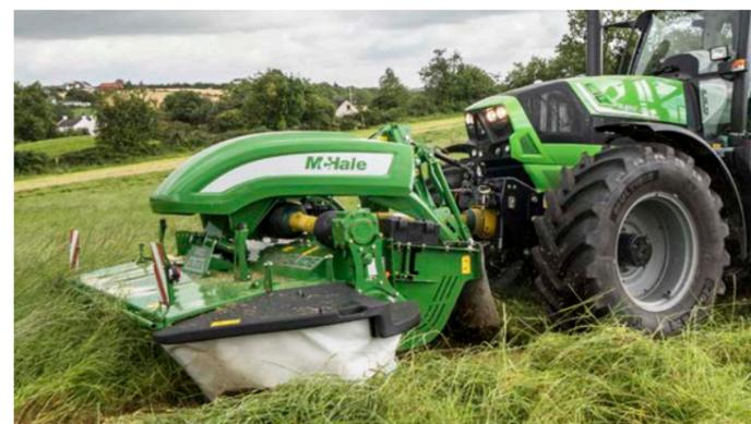
17度の横方向ピボット角度範囲では、カッターバーに過負荷をかけることなく、圃場面の状態に応じてカッターバー角度を左右にピボット可動することができます。
