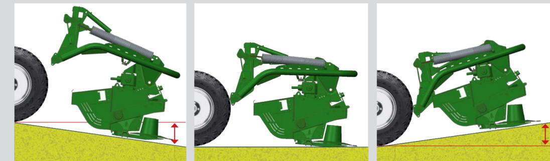
プログライドフロントモアは独立したサスペンションを装備することによって、モアはトラクターとは独立して自動的に上下に可動し、垂直可動範囲は500 mmです。くぼみなど圃場面の不均一な部分を刈取りする場合は、カッターバー角度が圃場面に合わせて自動的に調整されます。
