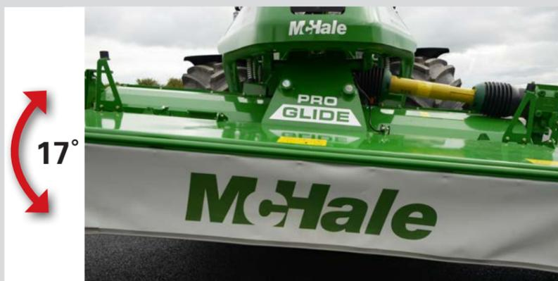
マッケールプログライドのフロントモアシリーズには、特許取得済みのアクティブスプリング補正技術が採用されています。これにより、モアカッターバーは作業高さに関わらず常に均一な接地圧で作業できます。
