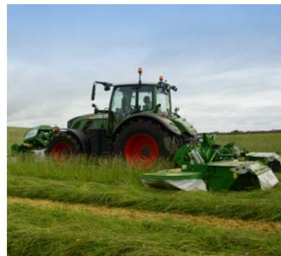
プログライドシリーズのリアモアには特許取得済みの圃場適応技術が採用されており、カッターバーに小さな障害物等が接触した場合には、カッターバーは後方に動き持ち上がります。この保護機構が作動することで、収穫作業時間のロスを防ぎ、作物の処理量を最大にします。これにより、スムーズでより速い刈取り速度で作業できます。
