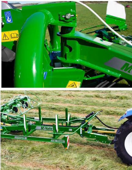
T8-1020けん引式テッターは、機械の全長を短くするロアーリンク2点アタッチメントによってトラクターに連結されます。リンケージ・ヘッドストックの後方で機械を旋回させることにより、トラクター後方に非常に接近して追従するため、アクセスが困難な場所を移動する際に効果的です。
