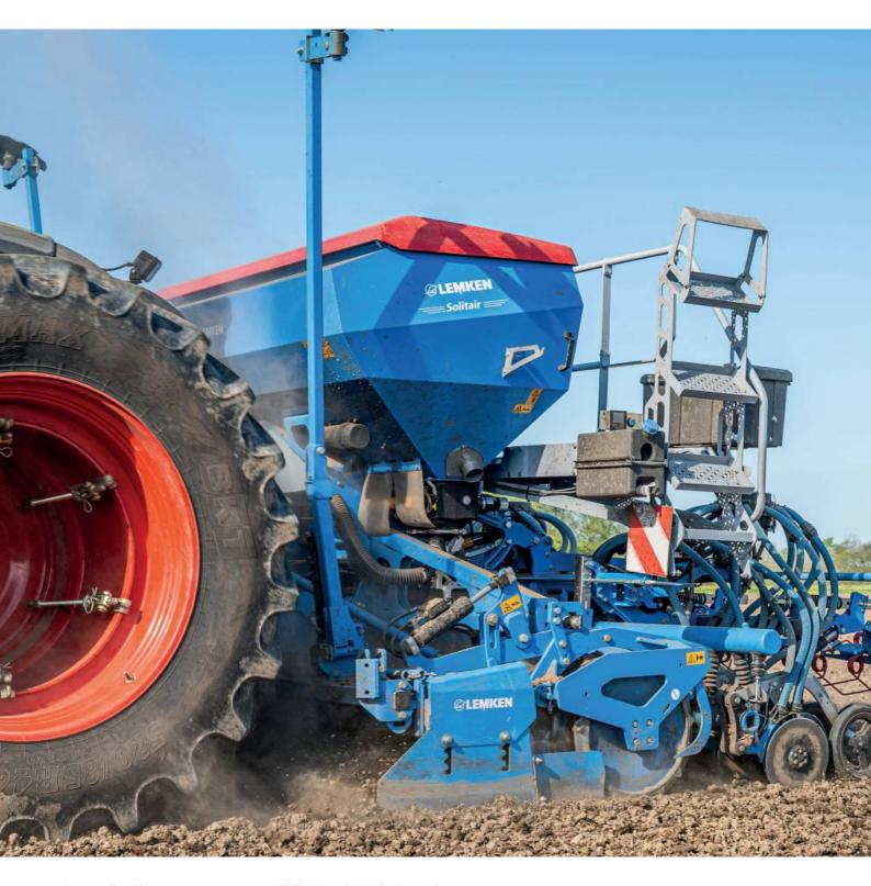
畑で発芽を均一にするのには、よく準備された播種床が不可欠です。 土壌の種類によって生産プロセスに対する要求が異なり、使用する機械も異なります。 さまざまな生産方法の要件を満たすために、土壌の種類に応じてSolitair MRをパワーハローまたはコンパクト ディスクハローに取り付けることができます。
