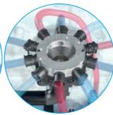
ディストリビューターカートリッジは簡単に交換できるため、 さまざまなトラムラインシステムにすばやく適応できます。 これにより、特に農場間で作業する場合に柔軟性が向上します。 ディストロビューターは種子ホッパーの外側、コールターバーの 真上にあり、簡単に開けて点検できます。ディストロビューター からコールターまで伸びる種子チューブは、正確な種子分配を確 実にするために同じ長さになっています。種子チューブの接続角 度が同じのため、詰まりを防止できます。
